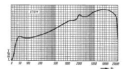
Potenza massima: 10 W Impedenza della bobina mobile: 7 Ω (9710M); 800 Ω (9710AM) Diametro del cono: 195 mm Frequenza di risonanza: 50 Hz Frequenza massima riprodotta: 20.000 Hz Induzione magnetica nel traferro: 8.000 gauss Flusso magnetico complessivo: 98.000 maxwell
